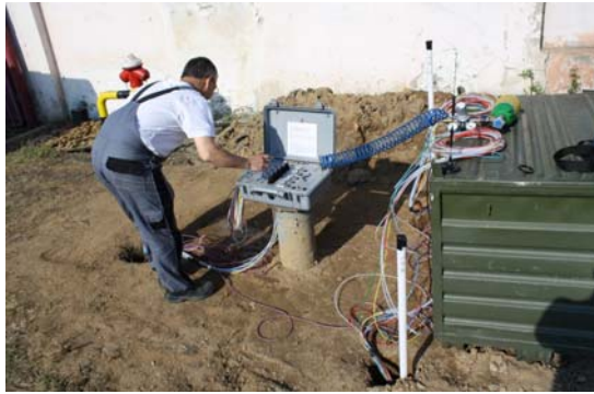
Spolchemie pilot site I, micropumps check (VEGAS/USTUTT)
